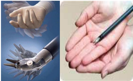
Slika 11. EndoWrist instrumenti, naznačena sličnost s pokretima ljudske ruke te njihova veličina
